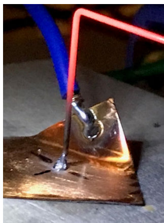
第3図 銅板上のGa系液体金属に通電している様子
